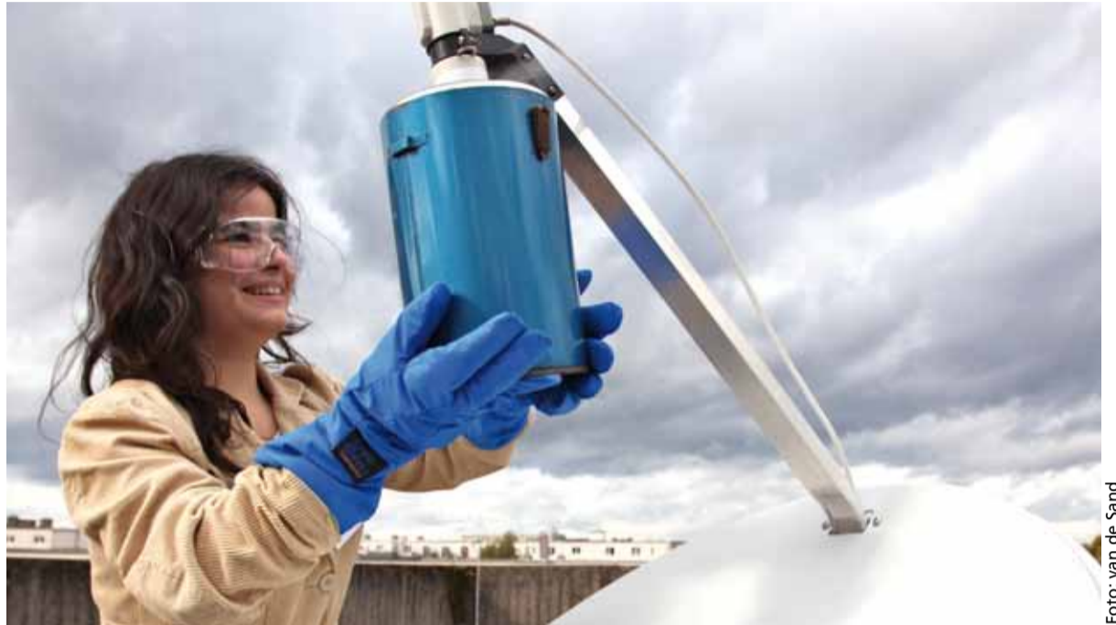
Eine Schülerin kalibriert das radioastronomische Messinstrument auf dem Dach des physikalischen Institutes.
