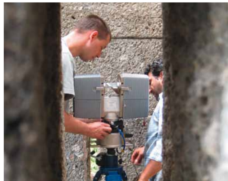
Dipl.-Ing. Claus Fleischer von der Erdbebenstation Bensberg und Dipl. Geol. Boris Yerli von der Ruhr-Universität Bochum bei der Vermessung eines Erdbeben-geschädigten Römischen Mausoleums in der Türkei mit einem Laserscanner.
