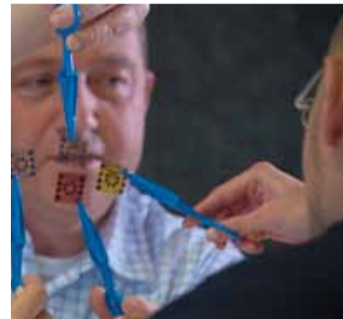
Der Kölner OLED-Prototyp misst gerade einmal 7 mm im Durchmesser
