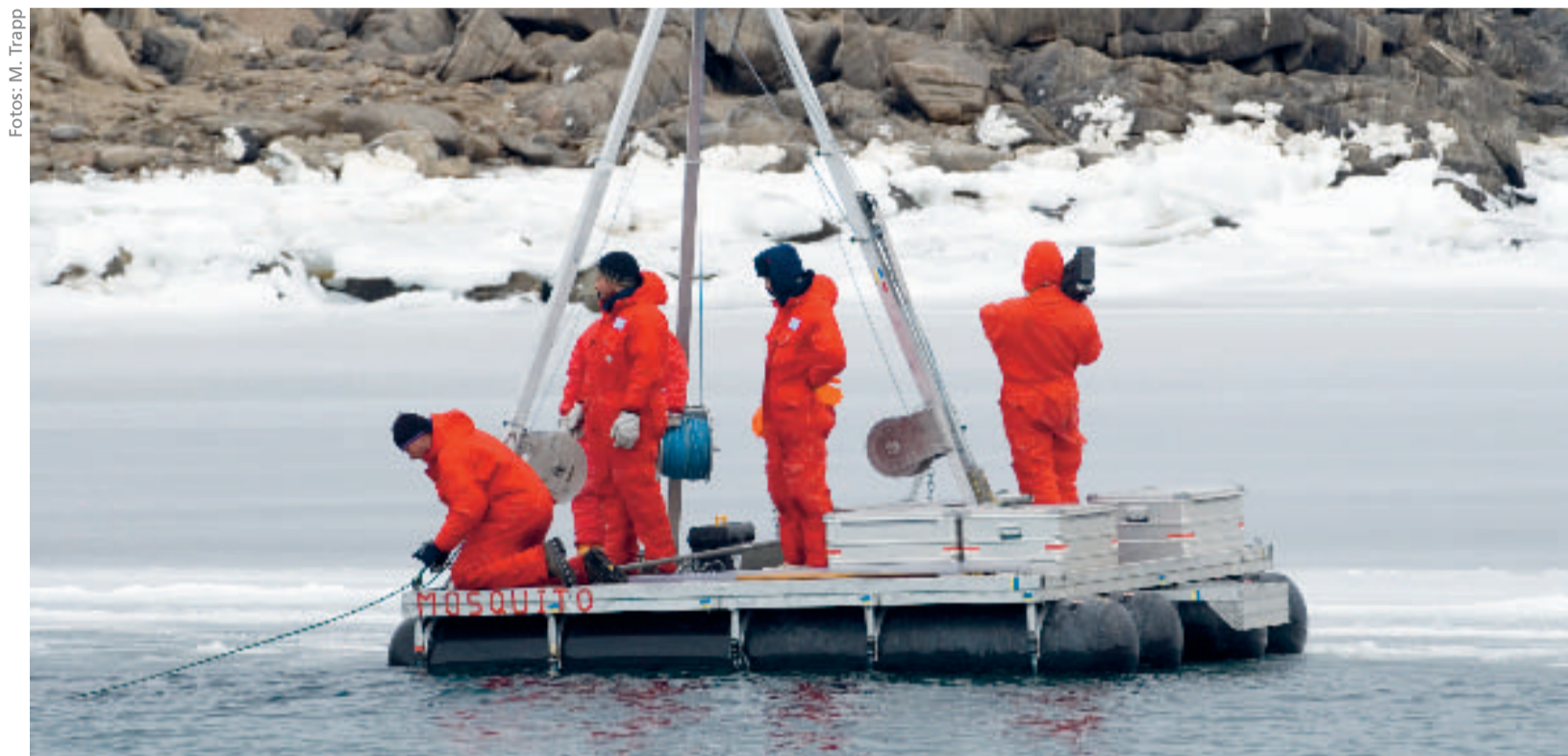
Die Arbeitsplattform der Geologen am Rande des Neueises: Zur Probenentnahme wird das Schwerelot zu Wasser gelassen.
